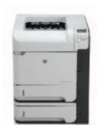
מדפסת HP LaserJet P4015x Printer • HP LaserJet P4015x: זהה ל-P4015tn פלוס יחידת הדפסה דו-צדדית אוטומטית עבור הדפסה דו-צדדית
