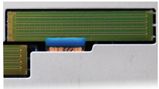
Εικόνα 8. Λεπτομέρεια μικροπλακιδίου HP Thermal Inkjet
