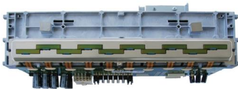
Εικόνα 7. Κάτω όψη μηχανισμού εγγραφής PageWide
