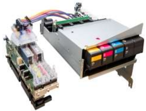
Figura 6. Conjunto del motor de escritura PageWide fuera del eje
