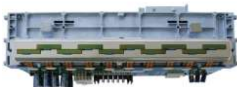
Figura 7. Vista inferior del conjunto del motor de escritura PageWide
