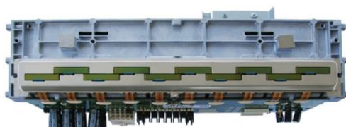
7. ábra: PageWide írómotoregység alulnézete
