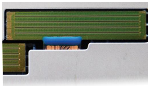
Figura 8. Pormenor de uma matriz HP Thermal Inkjet
