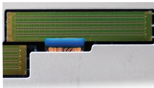
Figura 8. Pormenor de uma matriz HP Thermal Inkjet
