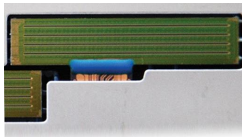
Figura 8. Detaliile unei matrițe HP Thermal Inkjet
