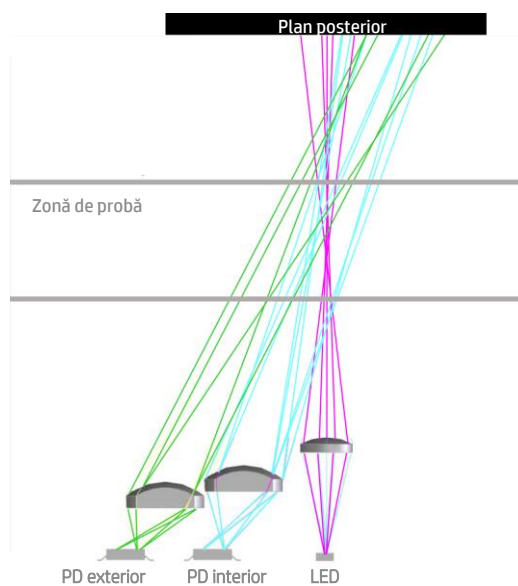
Figura 9. Schemă de principiu a Detectiei picăturilor prin retro-difuzie (modulul BDD)
