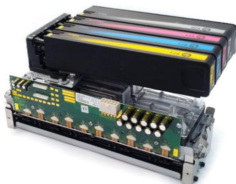
Рисунок 5. Печатающий механизм шириной во всю страницу, соответствующий технологии расположения «на оси».
