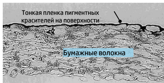
Рисунок 4. Пигментный краситель HP на универсальной бумаге HP, созданной по технологии ColorLok®
