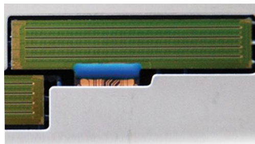
Рисунок 8. Увеличенное изображение кристалла HP PageWide
