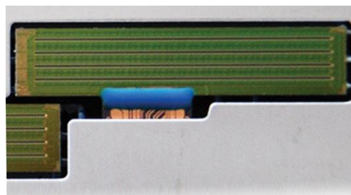
Obr. 8. Detail matrice tlačovej hlavy HP Thermal Inkjet
