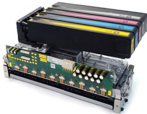
Şekil 5. Eksen üstü PageWide yazdırma motoru düzeneği
