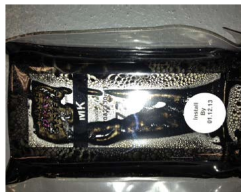
Cartucho remanufaturado recebido com defeito e vazando
