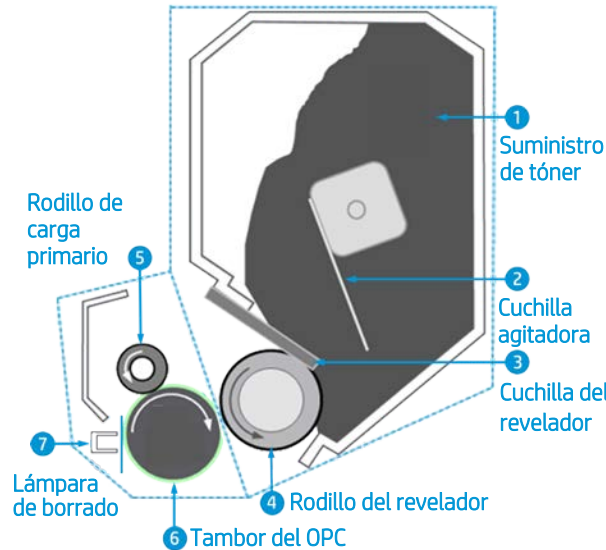
Sistema del cartucho de dos piezas compuesto por el cartucho de tambor de imágenes y el cartucho de suministro de tóner
