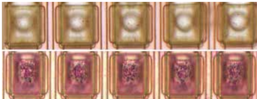
Con tintas originales HP Latex, boquillas en buen estado
