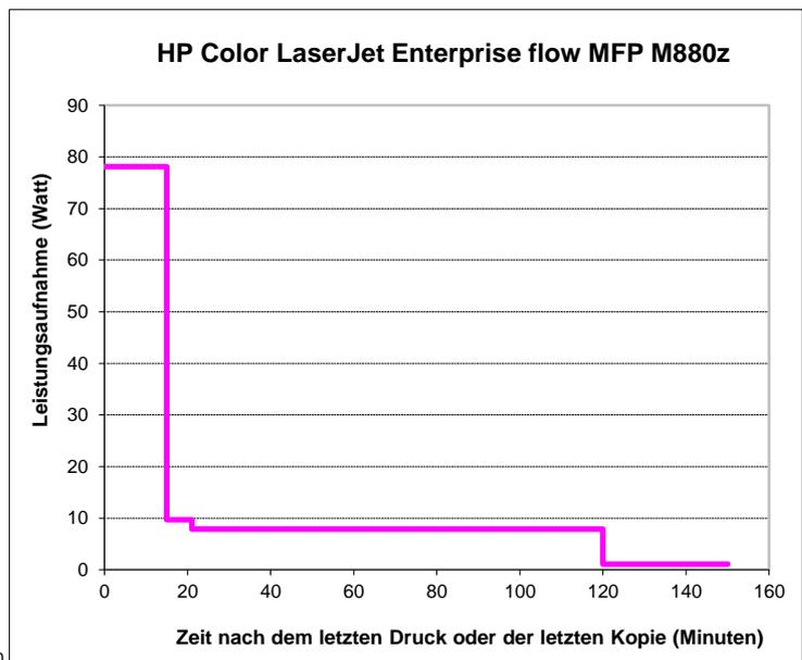
Das Gerät ist so ausgelegt, dass es bis zu zweimal täglich durch das Drücken des An/Aus-Schalters in den Zustand Aus (Plug-in Off) versetzt werden kann, ohne Schaden zu nehmen. Dieses Gerät hat keinen Schalter, der das Gerät vollständig vom Netz trennt. Wenn Sie nach dem Ausschalten des Gerätes den Netzstecker ziehen, wird eine elektrische Leistungsaufnahme völlig unterbunden.
