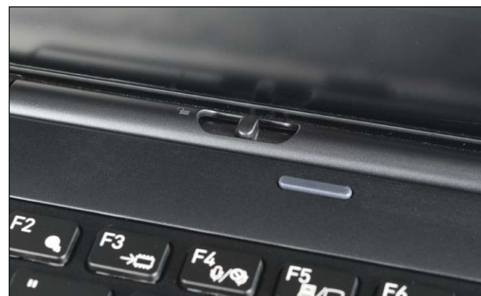
Mithilfe dieses Schiebeschalters lässt sich das Display des Portégé von der Tastatur lösen.
