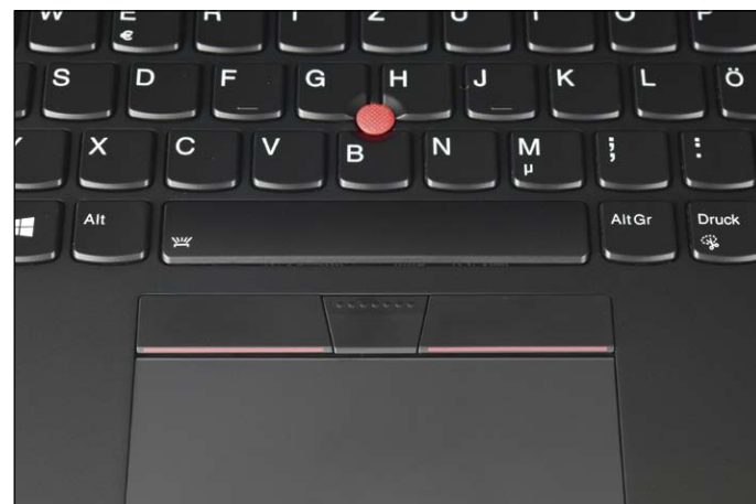
Als Vertreter der ThinkPad-Familie verfügt das X1 Yoga über einen Trackpoint sowie zusätzliche Maustasten oberhalb des Touchpads.
