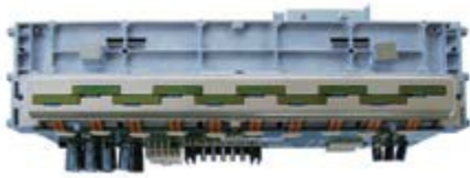
Abbildung 4: Writing Engine Baugruppe, Ansicht von unten
